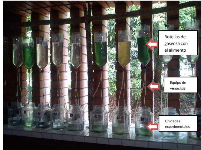
Figura 2. Sistema de alimentación por goteo implementado para el desarrollo del experimento
